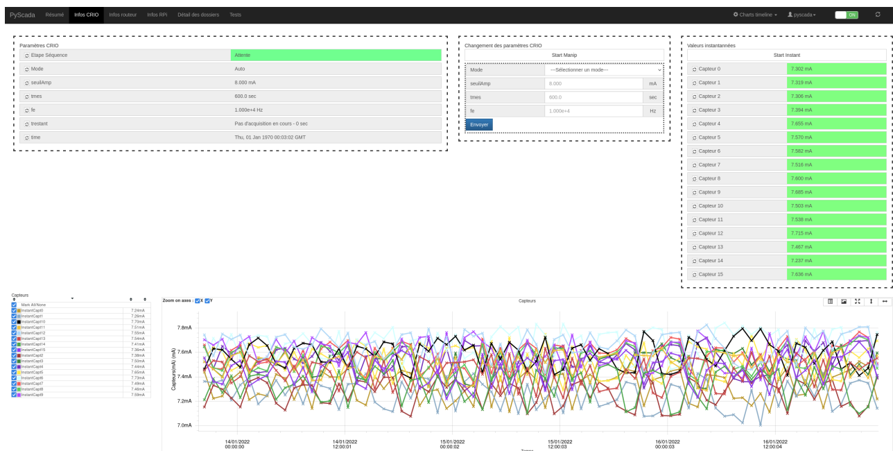
FIGURE 6.12 – Interface utilisateur de PyScada sur la station de la digue de l'Artha. En haut, les valeurs instantanées en lecture et/ou écriture. En bas, un graphique représentant l'état des capteurs (ici enregistrement de la pression atmosphérique).
